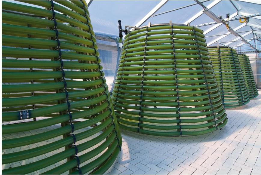
Figure 1: Fotobioreattore elicoidale a forma di cono troncopiramidale (fonte: gicon.de)
