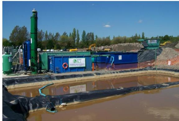
Figure 1: La tecnica di bonifica del Soil Washing
